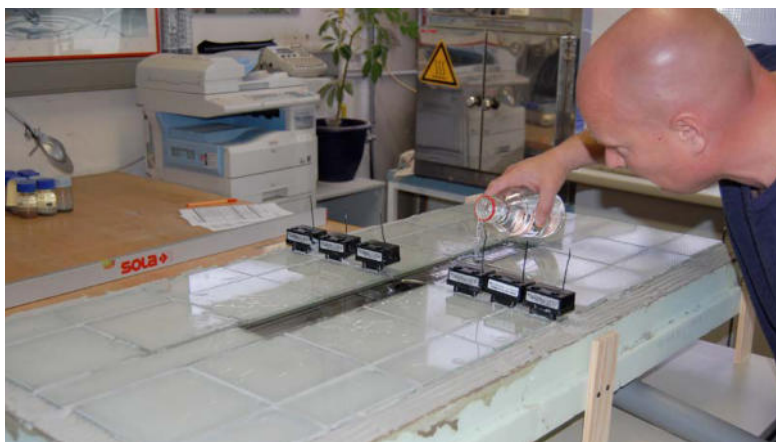
Abbildung 5: Zweiter Versuch - Beginn: Die Duschrinne wird mit Wasser gefüllt („geflutet“) - wie es beim Duschen typisch ist.
