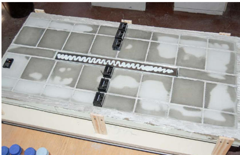
Abbildung 7: 47 Stunden nach Ablassen des Wassers aus der Rinne ist noch keine wesentliche Trocknung der feuchten Flächen unter den Glasfliesen eingetreten. Über die Sickerwasseröffnung kann die Feuchtigkeit nicht abtrocknen, die hohe Luftfeuchtigkeit in der Rinne stellt eine Verdunstungsbarriere dar. Anders als hier im Versuchslabor, wäre normalerweise die Dusche in der Zwischenzeit wieder benutzt worden, also wäre erneut Feuchtigkeit unter die Fliesen gelangt. (Der hier gezeigte Rinneneinsatz wurde mit Glasfliesen belegt (der Kleber ist durch die Glasfliese hindurch als Schlangenlinie sichtbar) und hat einen umlaufenden Wasserspalt von acht Millimeter. Die befliesten Abdeckungen sind die mit Abstand beliebtesten Rinnenabdeckungen.
