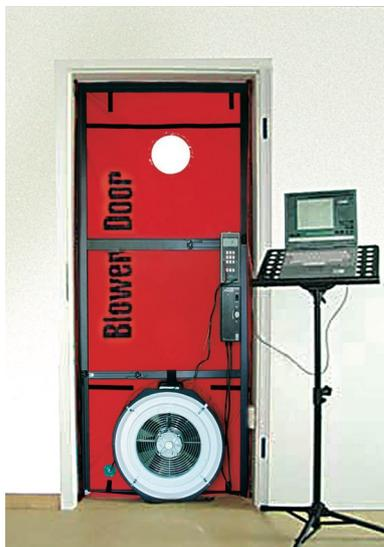
Bild 56: Differenzdruckverfahren nach DIN EM 13829 / Blower-Door-Methode zur Messung der Luftdichtheit eines Gebäudes
