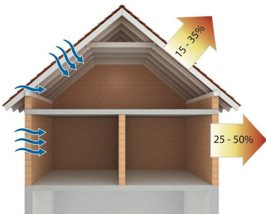
Bild 41: Wärmeverluste über die Außenwand
