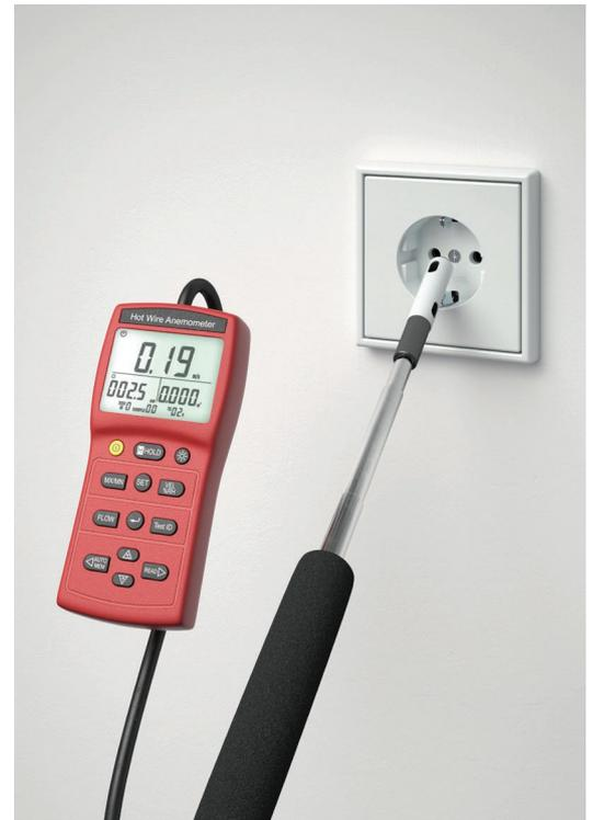
Bild 58: Leckageortung und Messung der Luftdichtheit mittels Thermoanemometer
