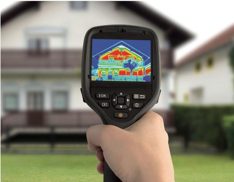
Bild 3: Wärmebrückenlokalisierung mit einer Infrarot-Thermografieaufnahme
